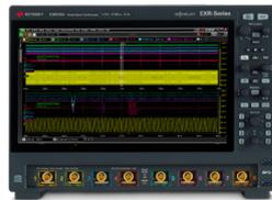
**Infiniium EXR | Real-Time Oszilloskop, 16-Bit HighRes-Modus, minimales Rauschen von 43  $\mu$ V**
