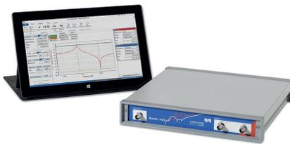
**Bode 100 | Vektor-Netzwerk- & Impedanz-Analysator,
